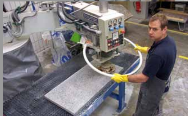
Bearbeiten einer Betonwerk- steinplatte mittels Wandarm- schleifgerät
