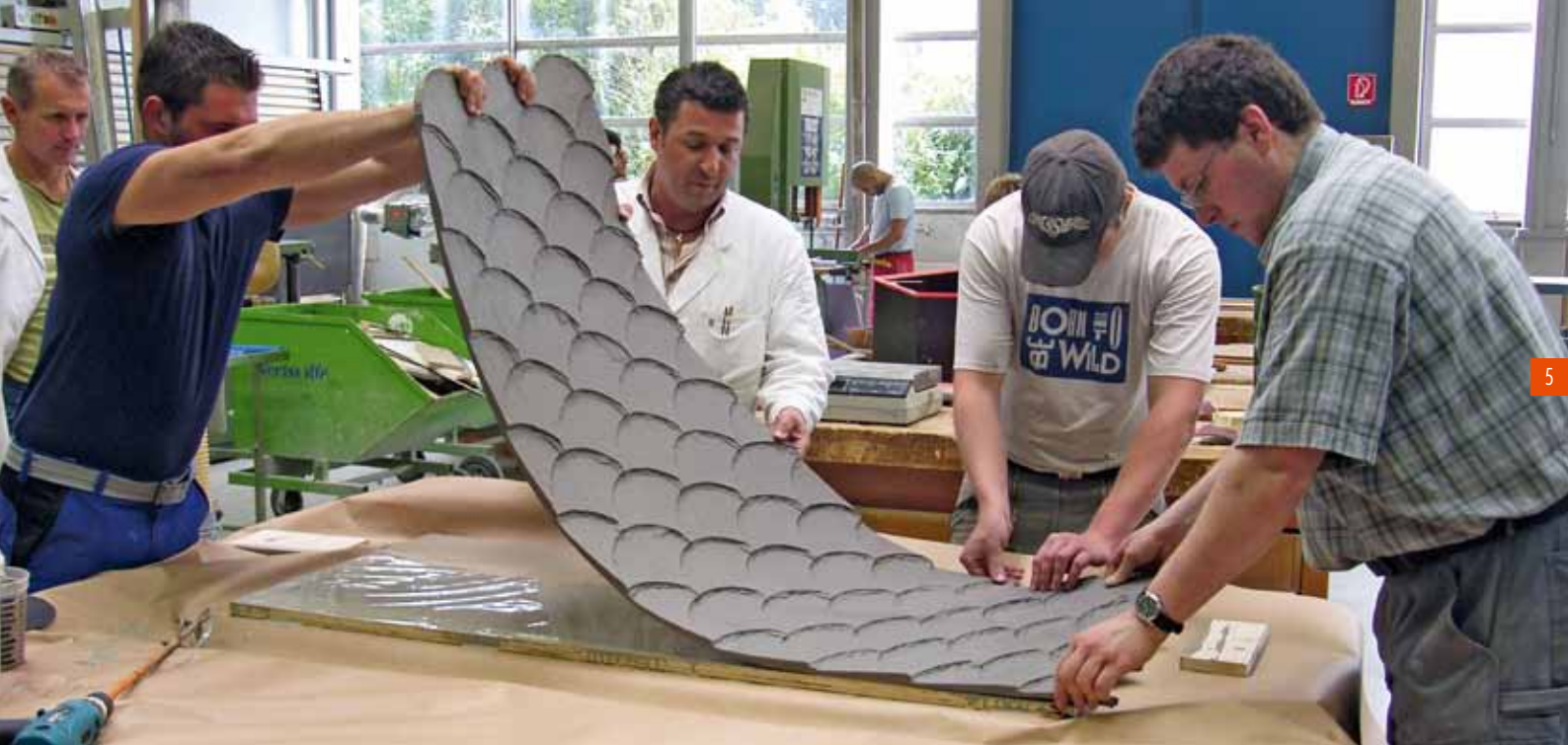
Befestigung einer Schalungsmatrize
