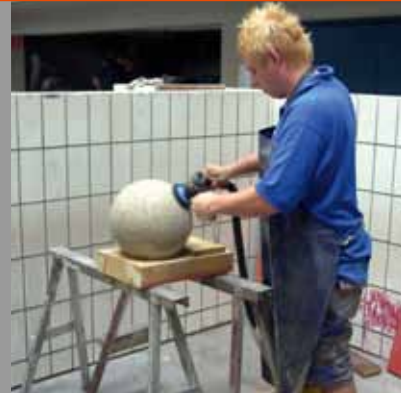
Rundschleifen einer Kugel mittels Handschleifgerät
