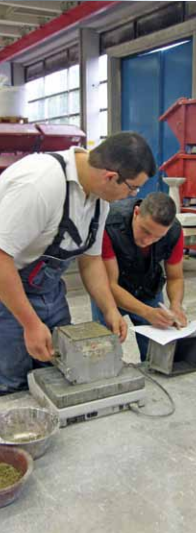
Bestimmung der Frischbetonrohddichte mittels Würfelwiegung
