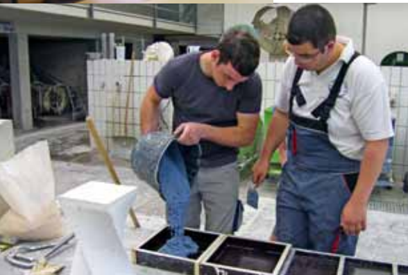
Günther Wiedenmayer, Technischer Lehrer, demonstriert die Bestimmung des Luftporengehalts am Frischbeton
