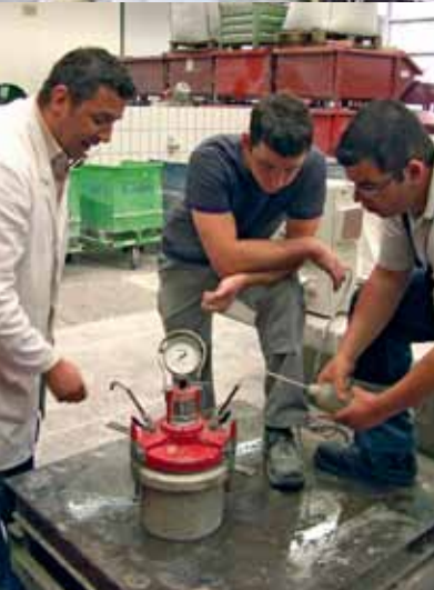
Günther Wiedenmayer, Technischer Lehrer, demonstriert die Bestimmung des Luftporengehalts am Frischbeton
