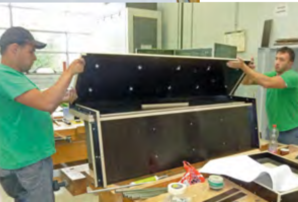
Komplexe Schalungs- teile werden manuell gefertigt
